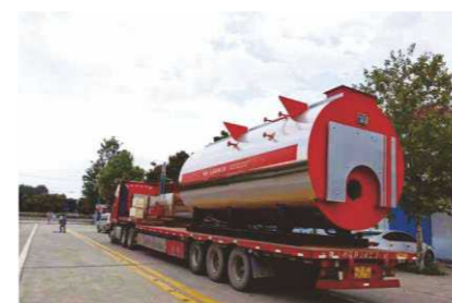
河南信阳粮业公司 10吨燃气冷凝锅炉 10t/h gas-fired condensing boiler for Henan grain industry
